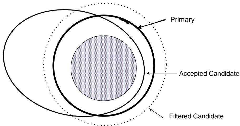
Figure 1. Apogee/Perigee Filter Principle<sup>9</sup>
